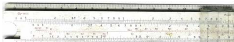
Fig. 5 - Il regolo calcolatore, basato sui logaritmi, introdotto da Nepero, è lo strumento di calcolo fondamentale fino al 1970
